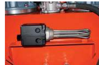
Ölheizung mit Zeitsteuerung
