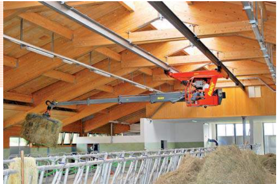
Die Statik des Gebäudes gibt die Hubkraft des Kranes vor
