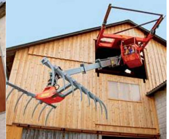
Verschiedene Greifer mit unterschiedlichem Volumen stehen zur Auswahl
