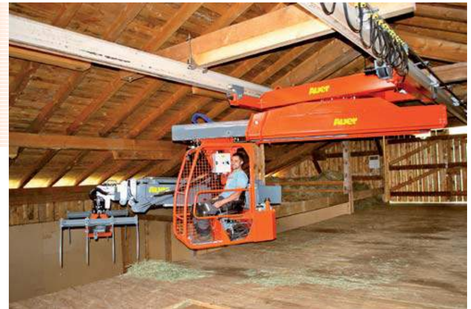
Discus Kran mit Doppeldrehwerk
