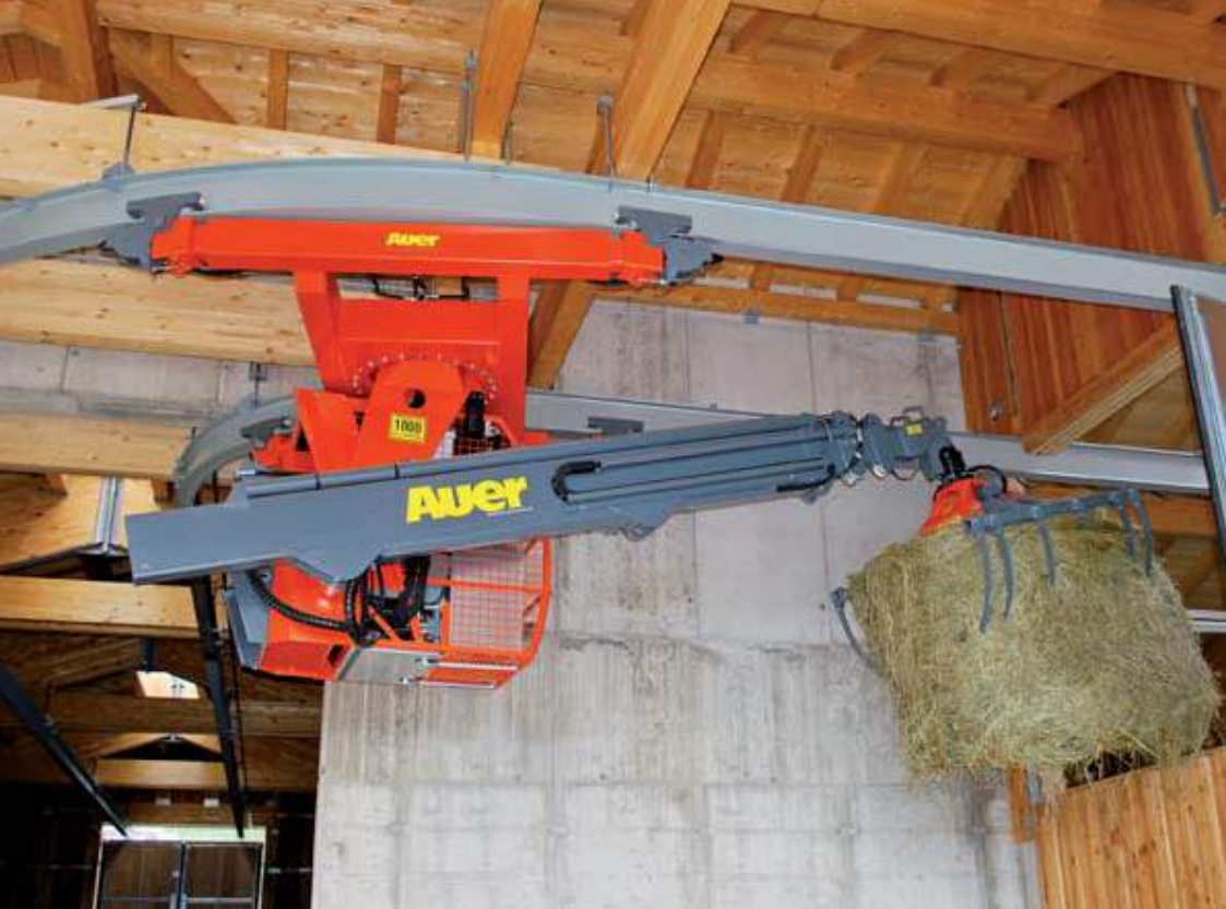
Saubere Schlauchführung in der Energiekette
