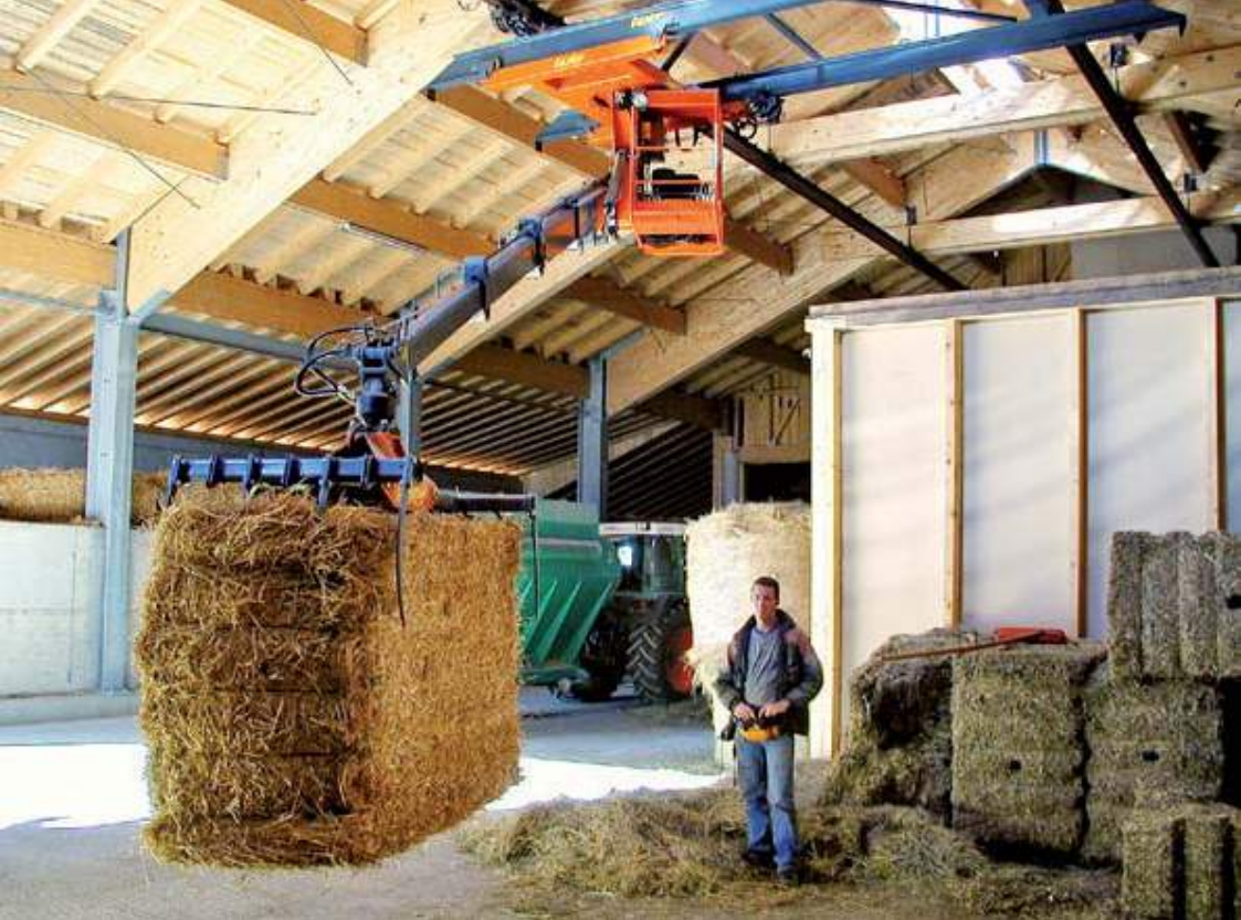
Kran mit Querfahrwerk und Funkfernsteuerung in Proportionalventiltechnik
