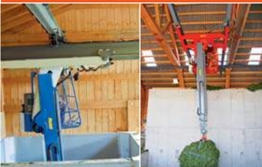
Fast senkrecht absenkbarer Telearme erleichtern die Futterentnahme
