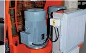
2-, 3- bzw. 4- Kreishydraulik mit Auer Powerjet- oder Trijet-Schaltung
