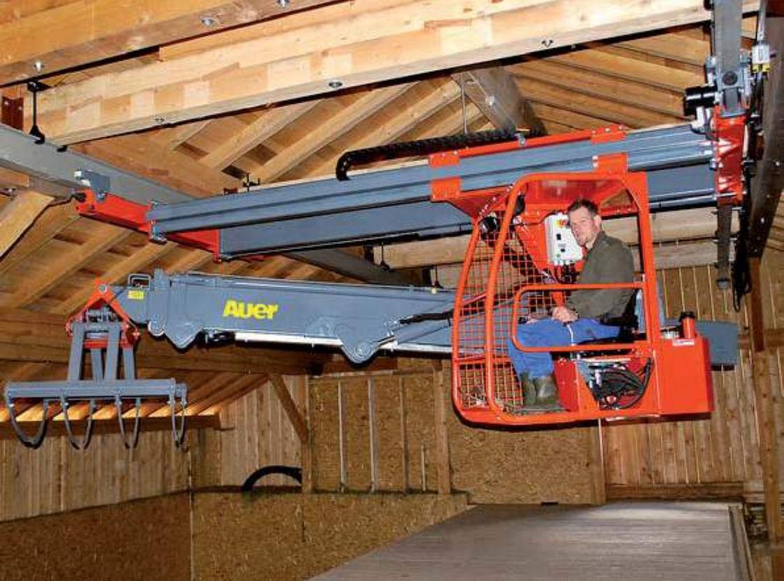
Verschubrahmen zur einfachen Futterentnahme aus der Belüftungsbox
