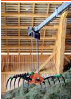
Greifer vorbereitet für weiter Zinken damit kurz geschnittenes Futter nicht durchfällt
