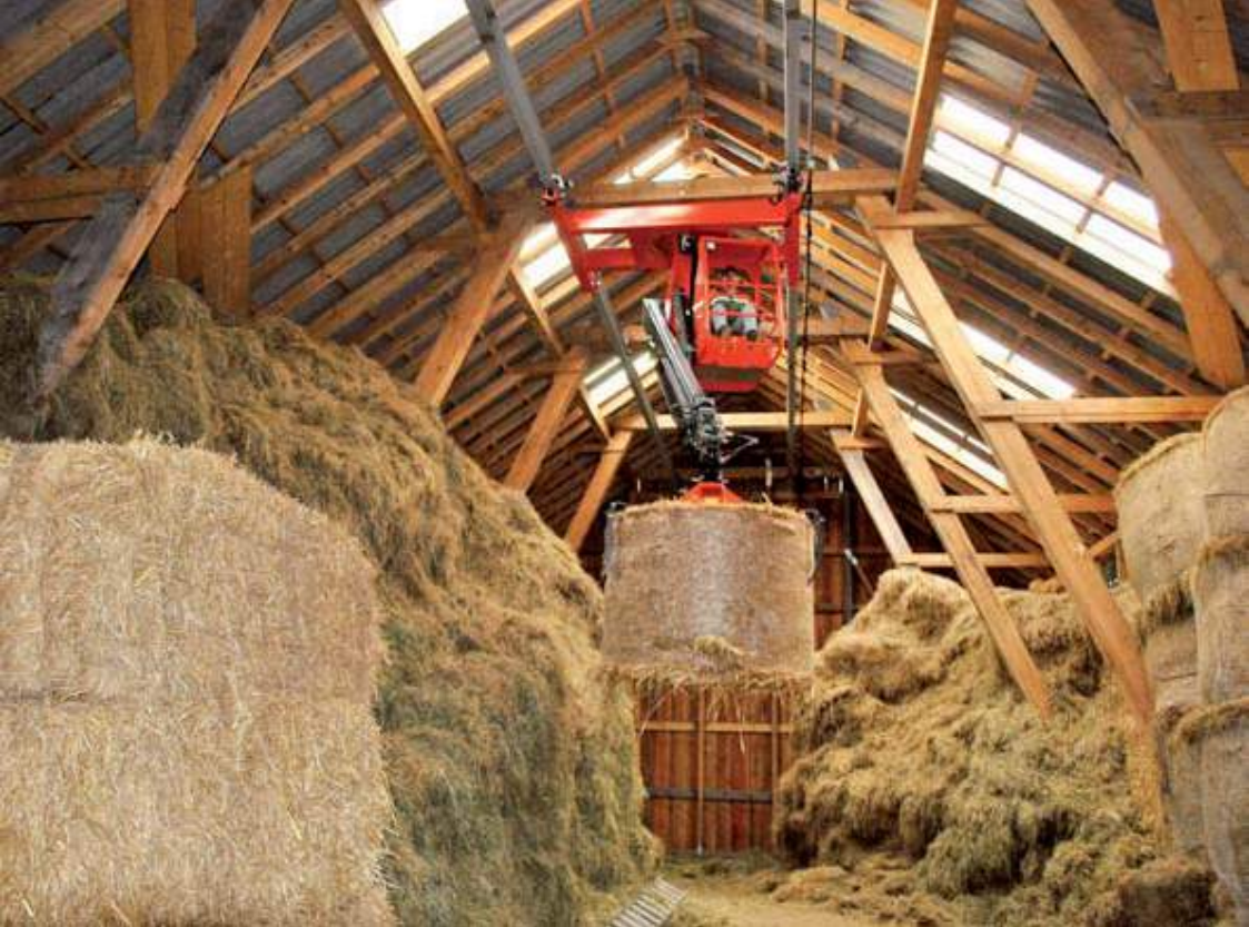
Teleskoparme mit kleinem Wenderadius und trotzdem großer Reichweite stehen zur Auswahl
