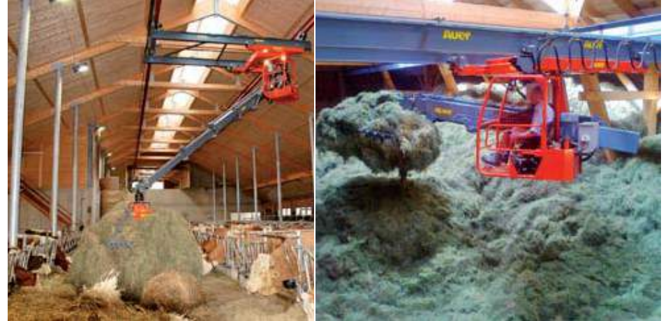
Robuste Kranbrücken schwingen weniger und erleichtern die Kranarbeit
