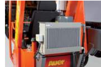
Ölkühler in verschiedenen Größen angepasst an die Hydraulikanlage
