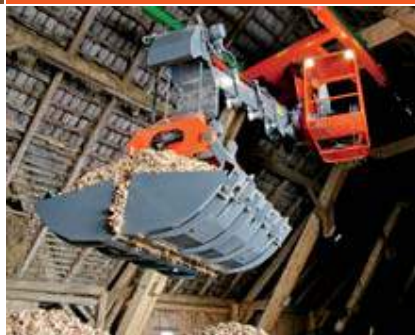
Stufenlos wird die Kettenwinde per Funk gesteuert
