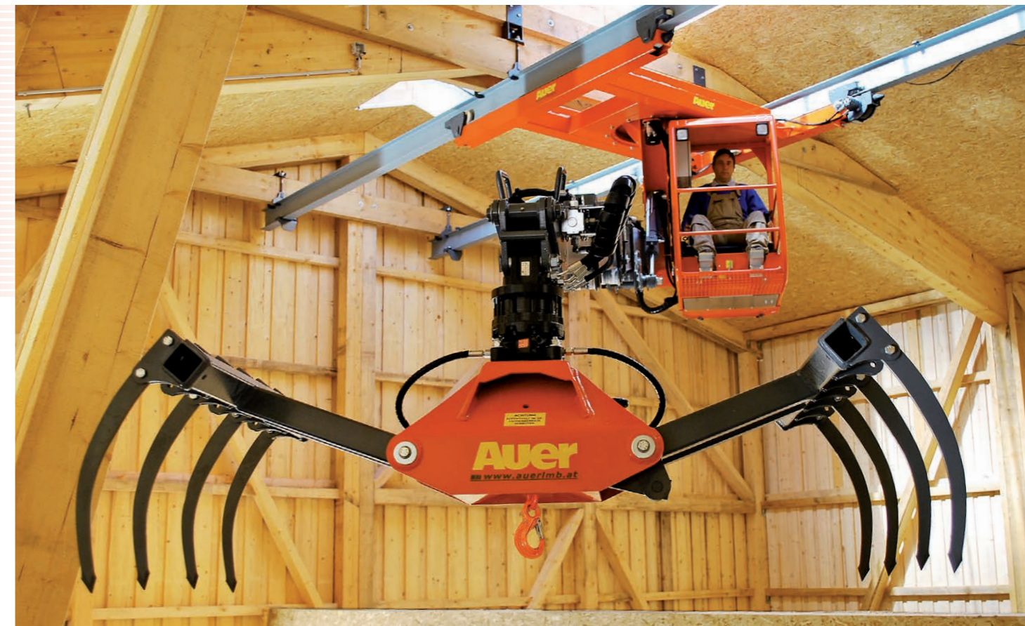
Un crochet de levage est souvent bien pratique sur la griffe
