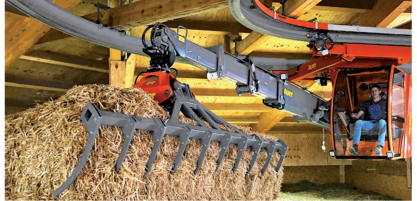
Les rails des voies courbes, ou en „S“ sont cintrés sur mesure
