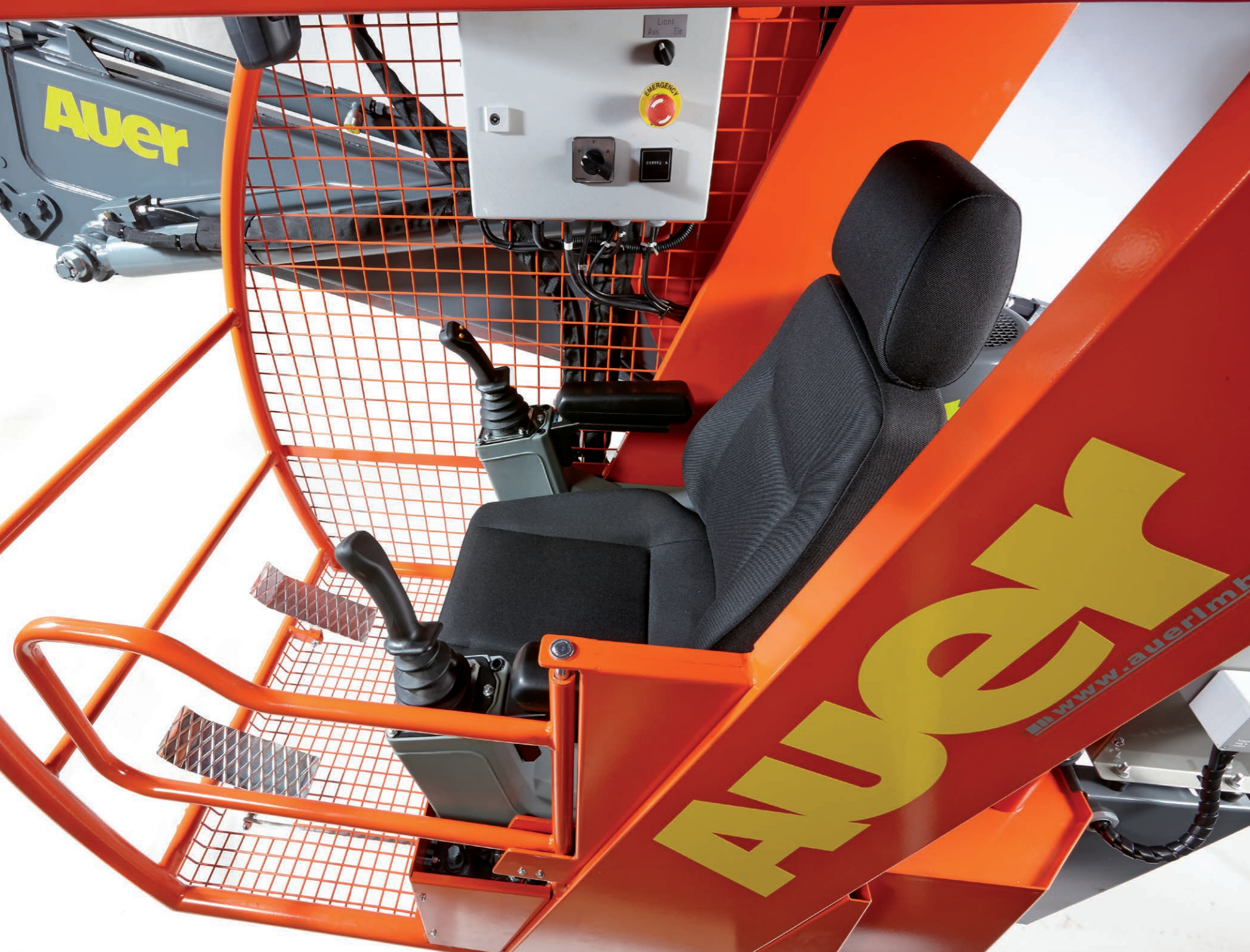
Accédez à une nouvelle dimension – Cabine design avec commande par joystick sur accoudoir
