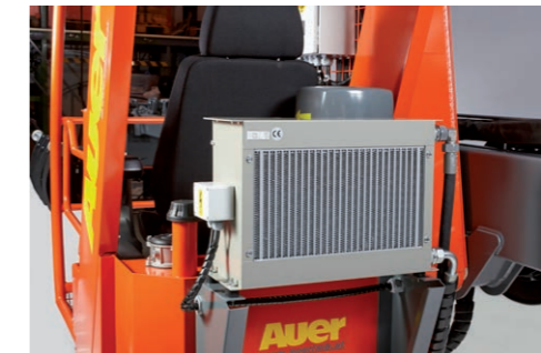
Refroidisseur d'huile (taille selon le système hydraulique)
