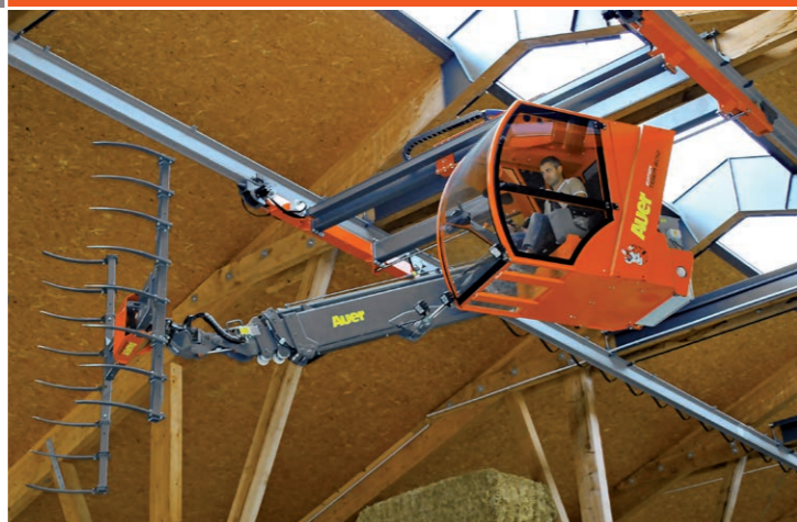
Si la hauteur sous toit est réduite, le châssis déportable est une bonne alternative au châssis transversal
