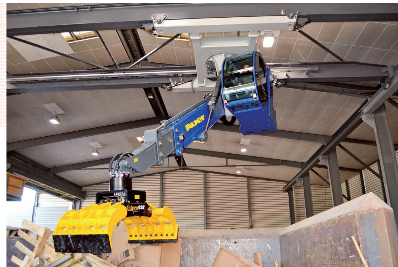
Grue industrielle pour le tri et le chargement de déchets
