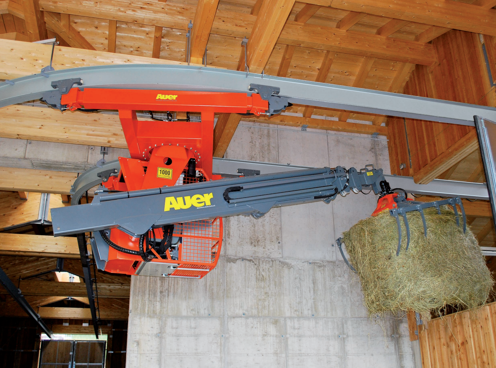
Guidage parfait des flexibles dans la chaîne d'alimentation
