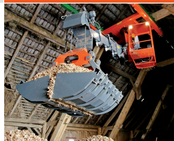
Grue avec treuil à chaîne radio-télécommandé
