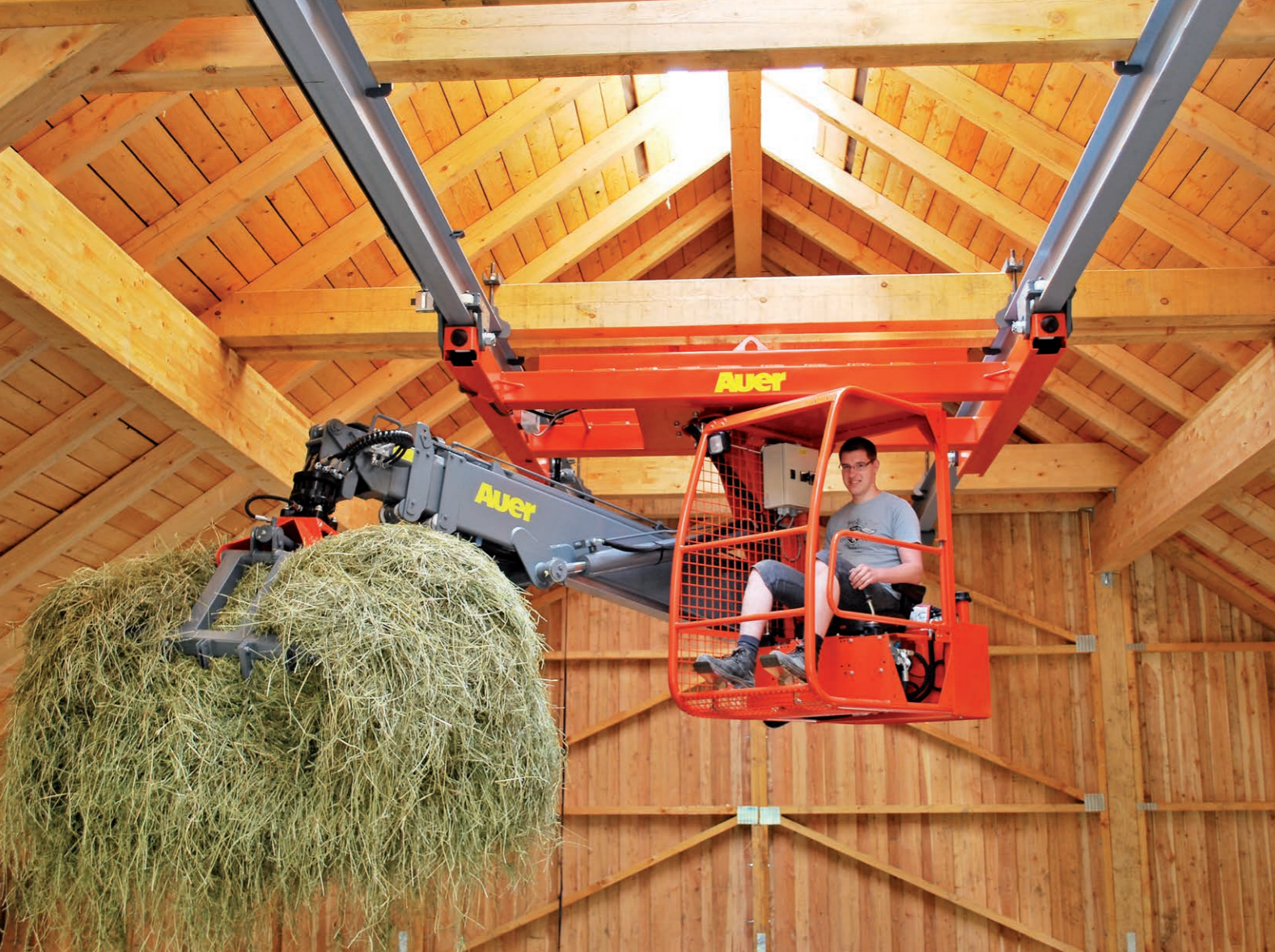
Dans les bâtiments sans poteaux, les flèches à double extension télescopiques démontrent leurs avantages
