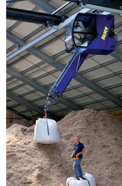
Commande de la grue via le joystick en cabine ou par radio
