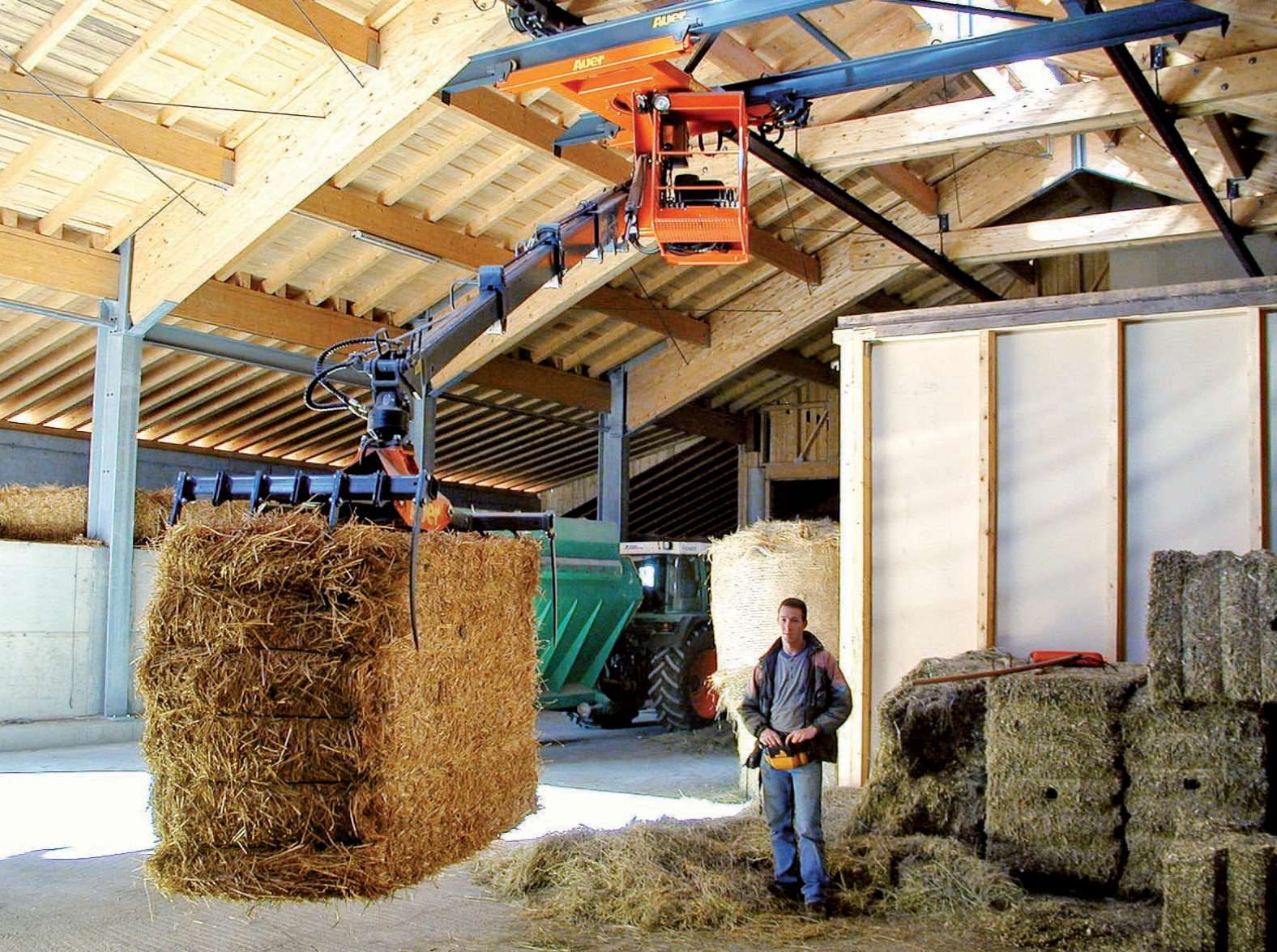
Grue avec chariot transversal, radiocommandée et avec distribution à débit proportionnel
